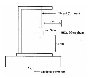
1 METER FROM MICROPHONE TO FAN INTAKE
