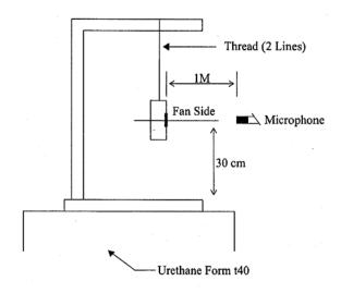
1 METER FROM MICROPHONE TO FAN INTAKE
