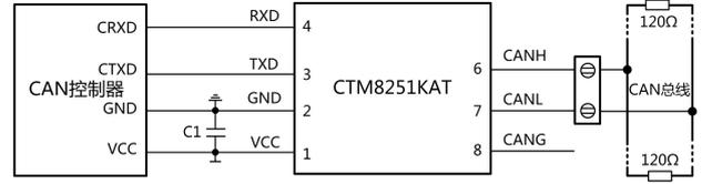
图 2. CAN控制器 3.3V 供电应用电路
