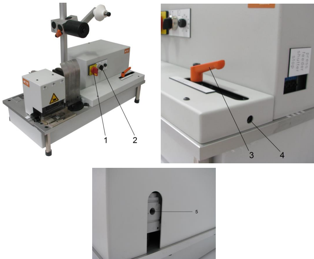
Abb. 22: Einstellung des Vorschubzylinders
