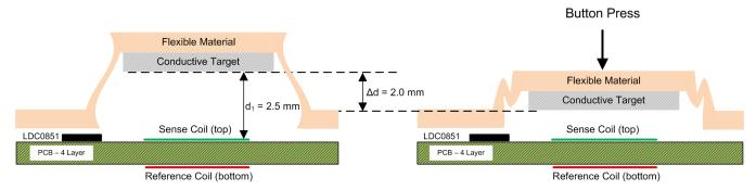
图 28. Coarse Position Sensing Side View
