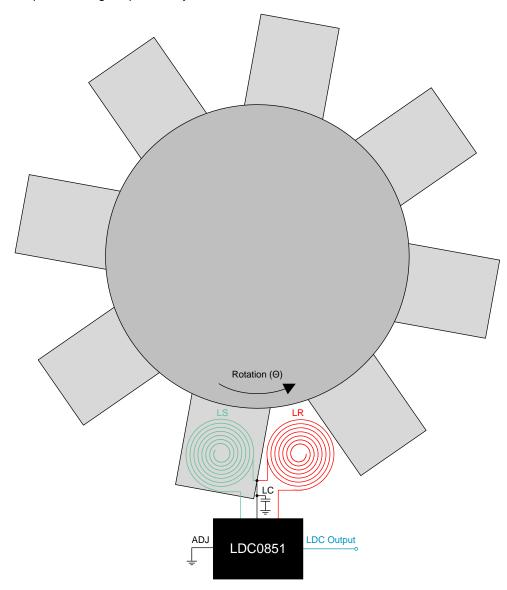
图 26. Gear Tooth Functional Diagram
