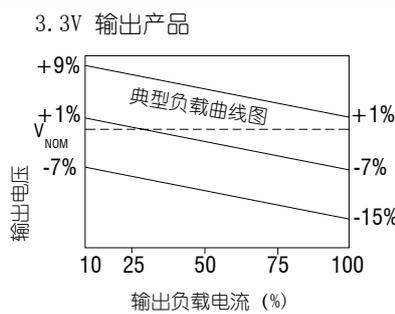
输出电压精度曲线图
