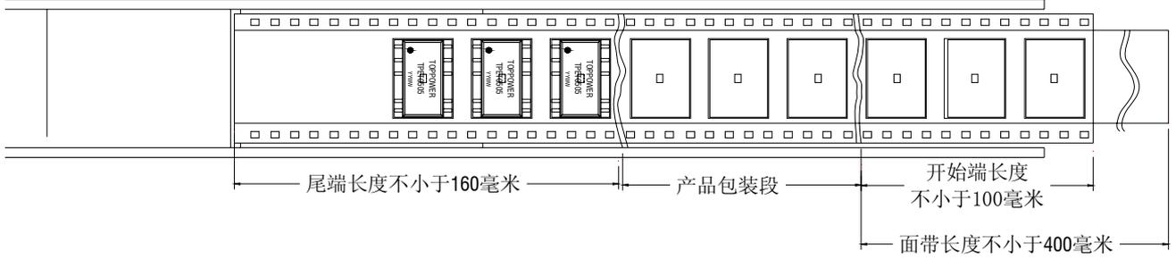
产品方向：端子1位于最靠近载体驱动链轮处
