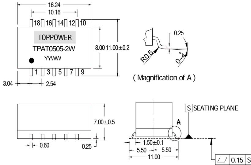
单位: 毫米, 未标注之公差:  $\pm 0.25$  毫米, 间距 2.54 毫米
