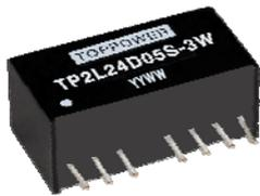
**产品描述:** 3W 1.5KVDC 3KVDC 隔离宽范围输入, 单、双输出 DC/DC 电源模块
