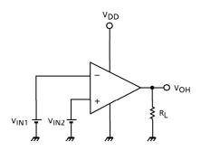
• V<sub>OH</sub> V<sub>IN1</sub> =  $\frac{V_{DD}}{2}$  - 0.05V V<sub>IN2</sub> =  $\frac{V_{DD}}{2}$  + 0.05V
