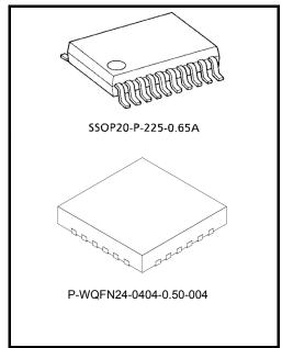
Weight: SSOP20-P-225-0.65A: 0.09g(typ.) P-WQFN24-0404-0.50-004: 0.03g(typ.)
