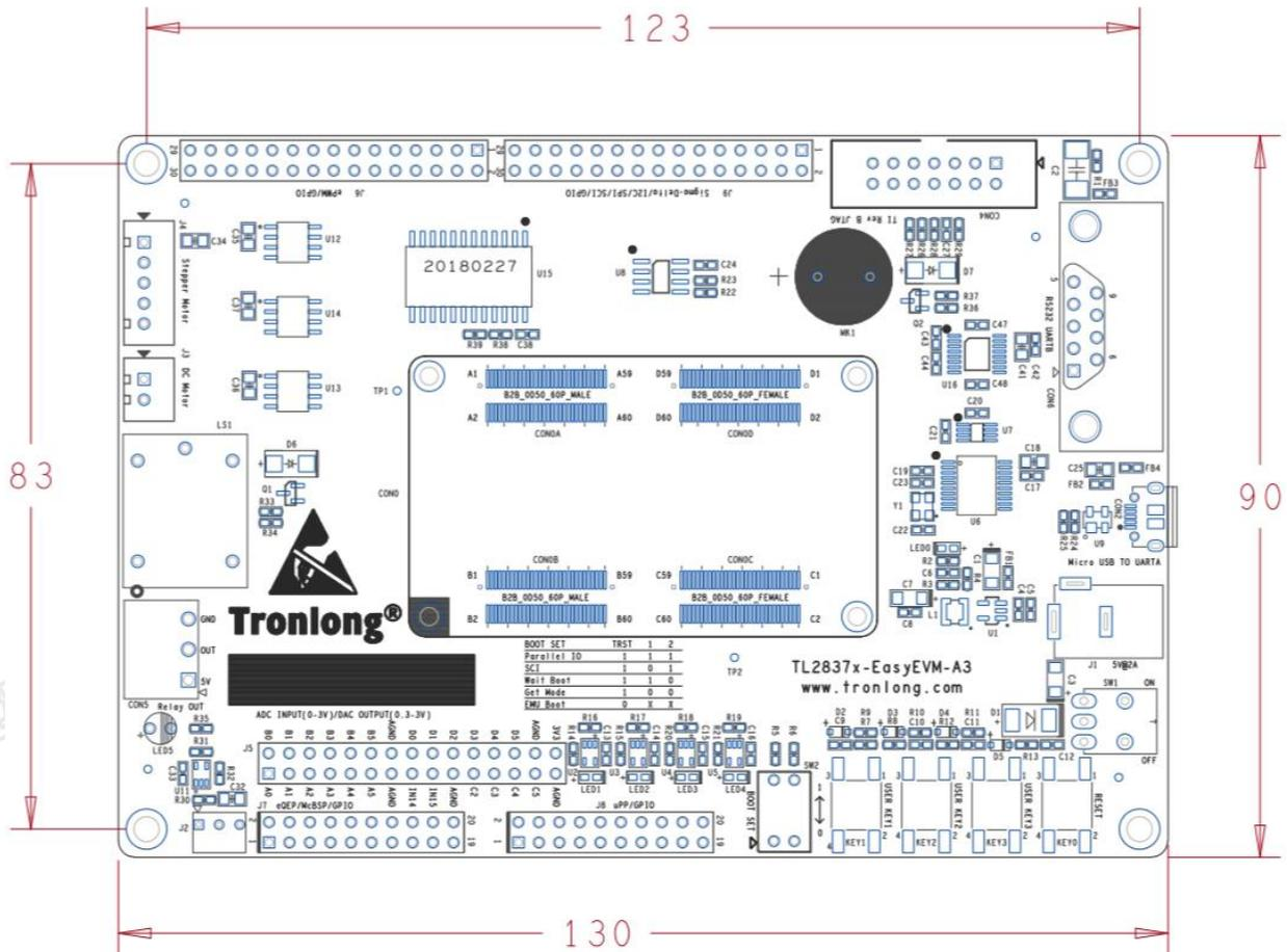
图 10 评估底板机械尺寸图
