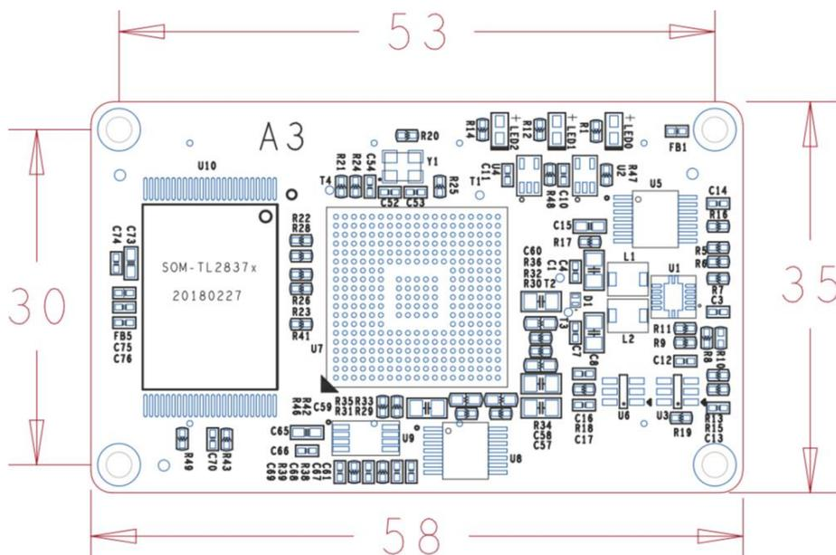
图 9 核心板机械尺寸图（顶层透视图）
