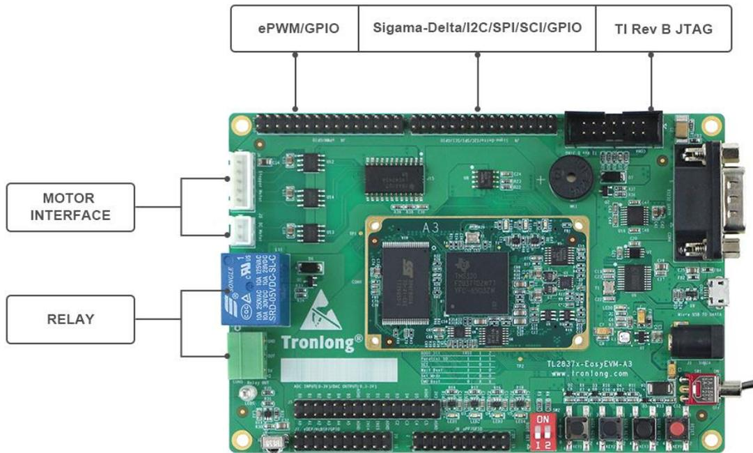
图 7 评估板硬件资源图解 1
