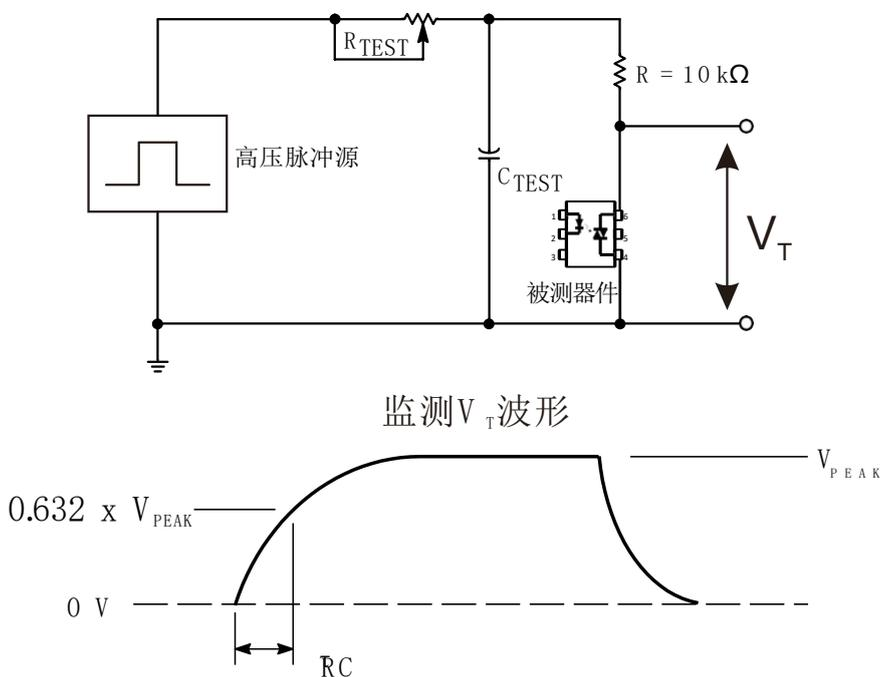
通过 RC 电路施加于被测器件的输出端的高电压脉冲设置到所需的  $V_{PEAK}$  值上。LED 电流无需加上。波形  $V_T$  使用 X100 探头监测。通过调节  $R_{TEST}$  值， $dv/dt$ （斜度）增加，直到被测器件观察到被触发（波形崩溃）。 $dv/dt$  然后下降，直到被测器件停止被触发。此时，记录  $\tau_{RC}$  值并可计算  $dv/dt$  了。
