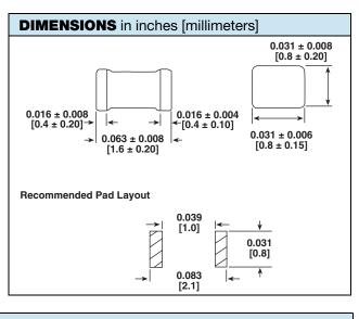
DESCRIPTION IMC-0603 10 nH ± 5 % ER e3 MODEL INDUCTANCE VALUE INDUCTANCE TOLERANCE PACKAGE CODE JEDEC® LEAD (Pb)-FREE STANDARD
