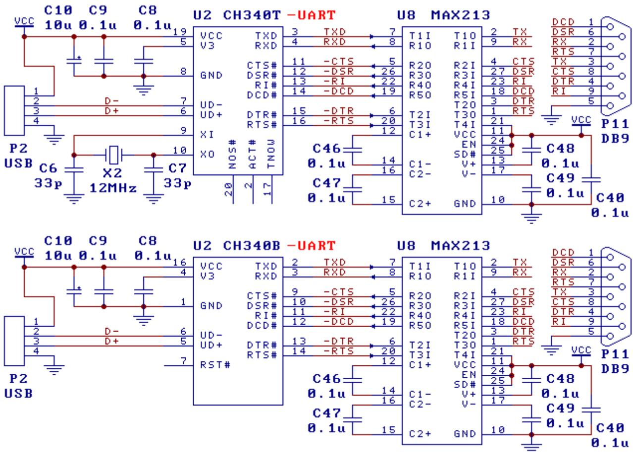
上图是由 CH340T(或 CH340C/B)实现的 USB 转 RS232 串口。CH340 提供了常用的串口信号及 MODEM 信号, 通过电平转换电路 U8 将 TTL 串口转换为 RS232 串口, 端口 P11 是 DB9 插针, 其引脚及功能与计算机的普通 9 针串口相同, U8 的类似型号有 MAX213/ADM213/SP213/MAX211 等。
