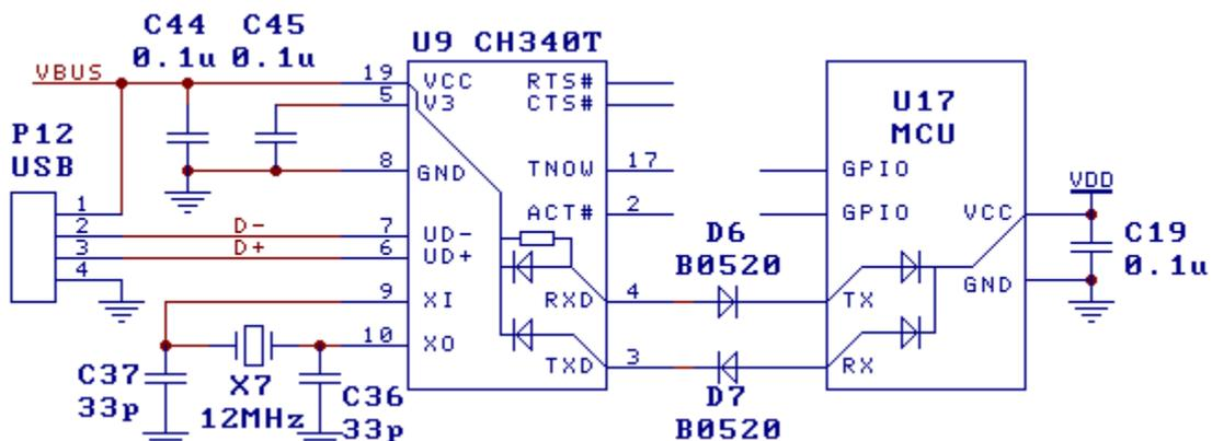
上图是双供电方式下 MCU 单片机通过 TTL 串口连接 CH340 芯片实现 USB 通讯的参考电路。CH340 由 USB 总线供电 VBUS，MCU 使用另一电源 VDD，VDD 支持 5V、3.3V 甚至 2.5V、1.8V，图中二极管 D6 和 D7 用于缓解双电源方式下 CH340 与 MCU 之间通过 RXD 或 RX 内部二极管产生电流倒灌的问题。图中 MCU 的 RX 引脚应该启用内部上拉电阻，如没有，则建议对 RX 引脚外加 8KΩ~30KΩ 的上拉电阻。
