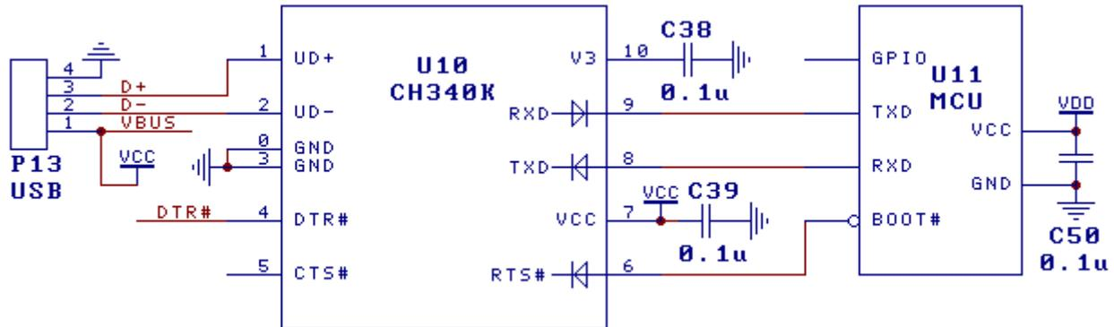
上图是双供电方式下 MCU 单片机通过 TTL 串口连接 CH340K 芯片实现 USB 通讯的参考电路。CH340K 由 USB 总线供电 VBUS (VCC)，MCU 使用另一电源 VDD，VDD 支持 5V、3.3V 甚至 2.5V、1.8V。CH340K 封装的底板是可选 GND 引脚，根据 PCB 走线方便选择连接 GND 或者悬空。
