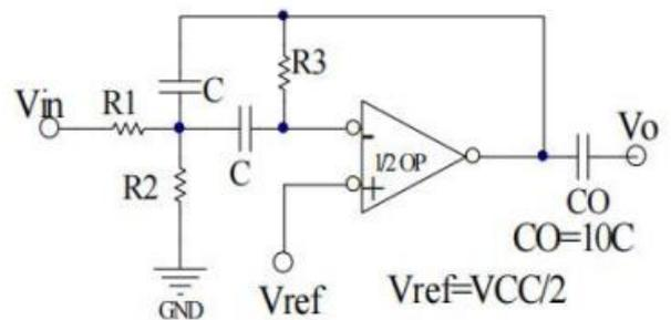
$f_o = \text{center frequency}$  多反馈带通滤波器
