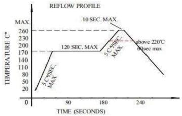
2、建议检查终端产品是否需要经历二次回流焊工艺,二次回流焊工艺具有一定品质风险性,如需请自行评估并尽量缩短二次回流焊间隔时间(建议不超过4小时);
