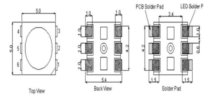
注: 1. 单位: 毫米 (mm) Unit: mm
