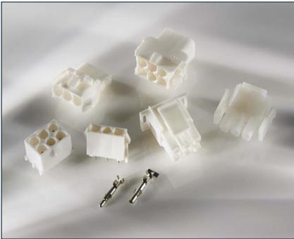
**通用MATE-N-LOK连接器**包括端子位置保证 (TPA), 以确保端子完全就位, 并在2-5位置内不会退回。护套中具有插针和插座触点, 这些触点可以在同一护套中混合使用。这些在暖通空调子应用中非常有用, 如控制板、人机界面、电源板和传感器。提供防溅密封型。
