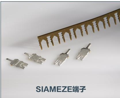
与MAG-MATE端子一样，TE Connectivity的SIAMEZE端子系统以IDC技术为特色，可在不剥离漆包线的情况下实现安全的金属对金属连接。SIAMEZE端子采用紧凑型设计，适用于更受空间限制的电机系统，并配有可选的Lead-Lok，可用高保持力固定引线。该系统适用于自动或手动组装，实现铜或铝漆包线的稳定、气密连接，无需预剥离。
