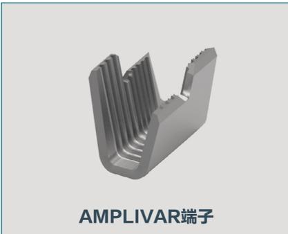
TE Connectivity的另一种端子是AMPLIVAR端子和接头，其特点是锯齿状筒形设计，用于穿透漆包线绝缘层，产生具有优异强度和可靠性的优质金属对金属压缩压接。使用新的应用工具，AMPLIVAR端子可以连接在一起，支持多线连接。压接可实现免焊和气密连接，没有与热端接相关的污染物、冷焊点、焊接烧伤和导线脆化。常见应用包括电动机和压缩机。
