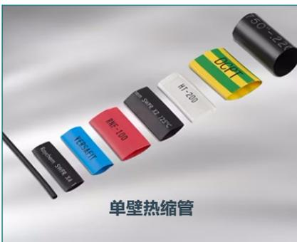
单壁热缩管具有绝缘，提供应力消除，并有助于防止机械损坏和磨损的功能。热缩管是对现场粘贴和成型等标准绝缘方法的一种高性能替代。热缩管有各种尺寸、颜色和材质。当加热时，它会收缩，以符合所包裹材料的大小和形状，从而使安装快速简单。
