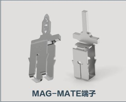
当今暖通空调系统中使用的组件可以帮助实现优化能源使用、可靠性和与系统要求的兼容性的目标。例如，TE Connectivity的MAG-MATE端子具有绝缘刺破连接（IDC），可创建气密性漆包线端接，而无需剥线或焊接。标准MAG-MATE端子支持34-12AWG漆包线，较小版本可用于细规格导线。有多种款式可供选择，包括插入式、插入式接线片、接头、压接线筒、焊柱等。TE提供空腔设计规范，以便将这些独特终端的空腔整合到线圈主体或其他定制外壳中
