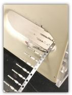
端子在压接机防护罩上撞伤
