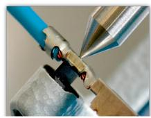
使用压接高度干分尺检查压接高度
