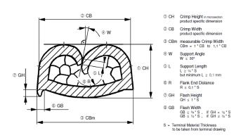
TE Connectivity 114-18022 规范中的压接横截面测量要求
