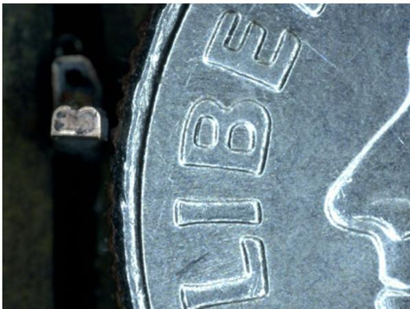
将导线横截面积为  $0.17 \text{ mm}^2$  的压接尺寸与 10 美分硬币的尺寸进行比较
