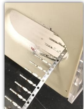
端子在压接机防护罩上撞伤
