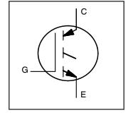
600V  $I_{C(nom)}=4.0A$   $V_{CE(on)}$  typ. = 1.75V @4.0A
