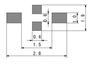
クリームはんだ塗布厚み Amount of solder Thickness : 150μm
