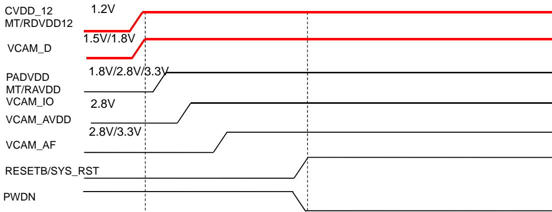
图 10 XC6121 与 sensor 上电顺序
