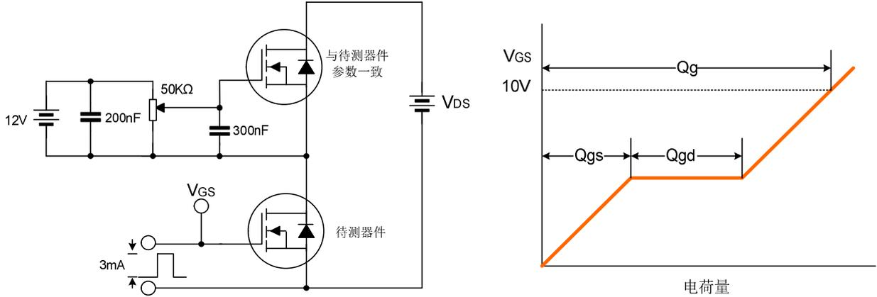
开关时间测试电路及波形图
