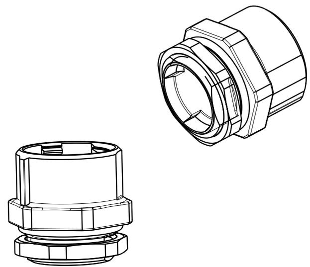
Sämtliche angegebene Daten beziehen sich auf die ≥IP54 montierten M12 Einbaustecker und setzen ein korrekt gestecktes und verriegeltes Steckverbinderpaar voraus. Empfohlenes Anzugsdrehmoment 0,4Nm. Einflüsse durch Litzen, Leitungen oder Leiterplattenmontage sind zusätzlich zu berücksichtigen.
