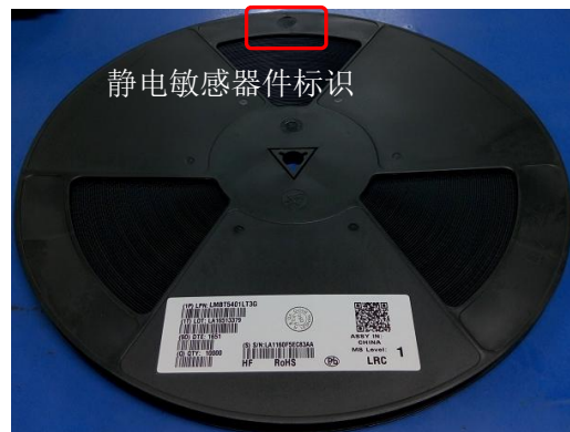
13英寸卷盘标签张贴及QA印章位置
