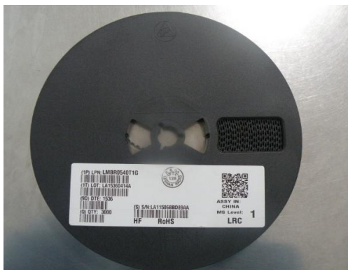
7英寸卷盘标签张贴及QA印章位置
