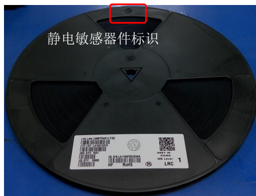
13英寸卷盘标签张贴及QA印章位置
