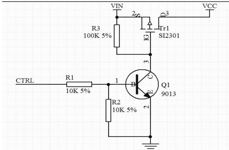
图 2.1.2 VCC 开关控制电路
