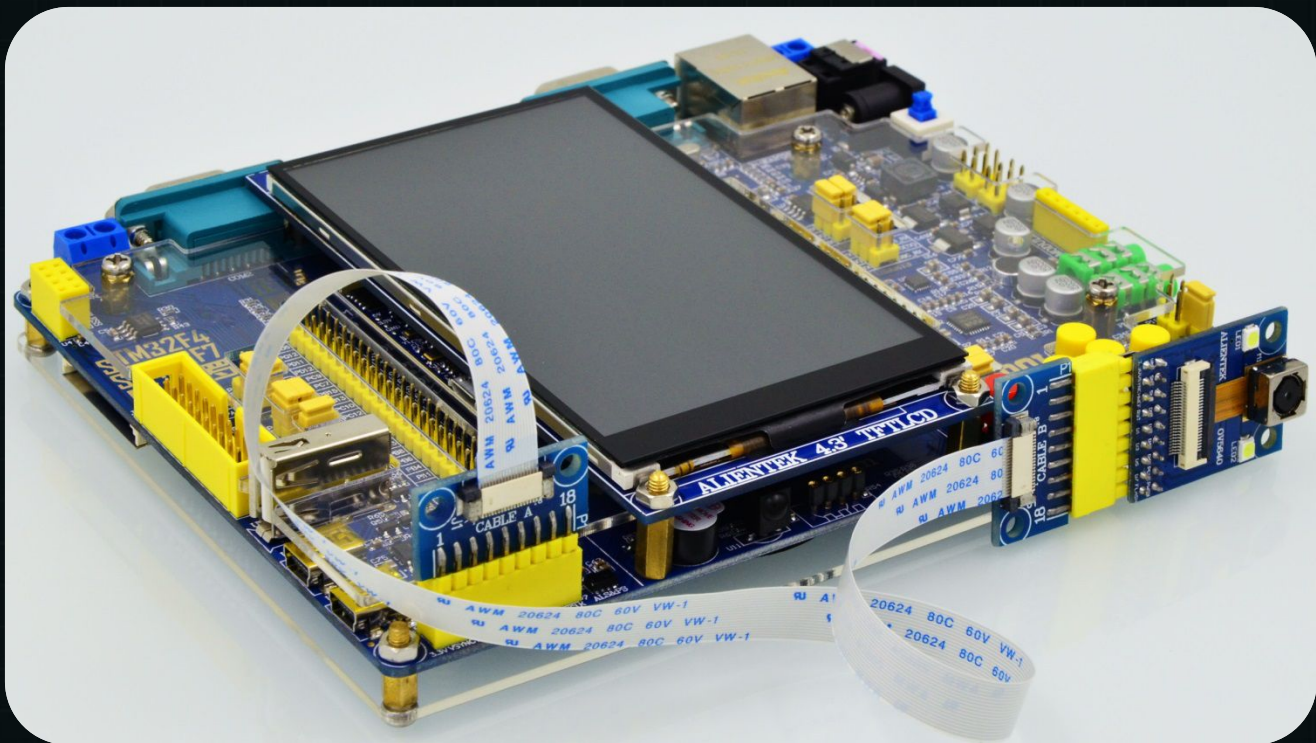
阿波罗F4/F7开发板与摄像头模块链接图（通过排线）
