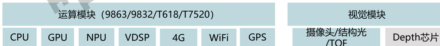
将Depth算法运行在CPU/GPU/VDSP中，无需额外Depth芯片
