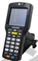
手持终端：体积测量（3D），字符/条码识别（RGB），人脸识别（RGB），通信...
