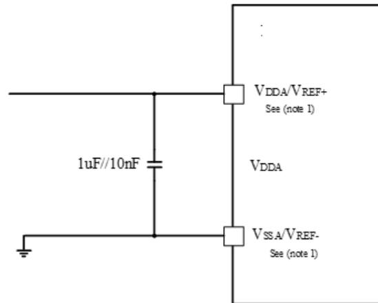
1.  $V_{REF+}$ 和 $V_{REF-}$ 内部与 $V_{DDA}$ 和 $V_{SSA}$ 相连接。
