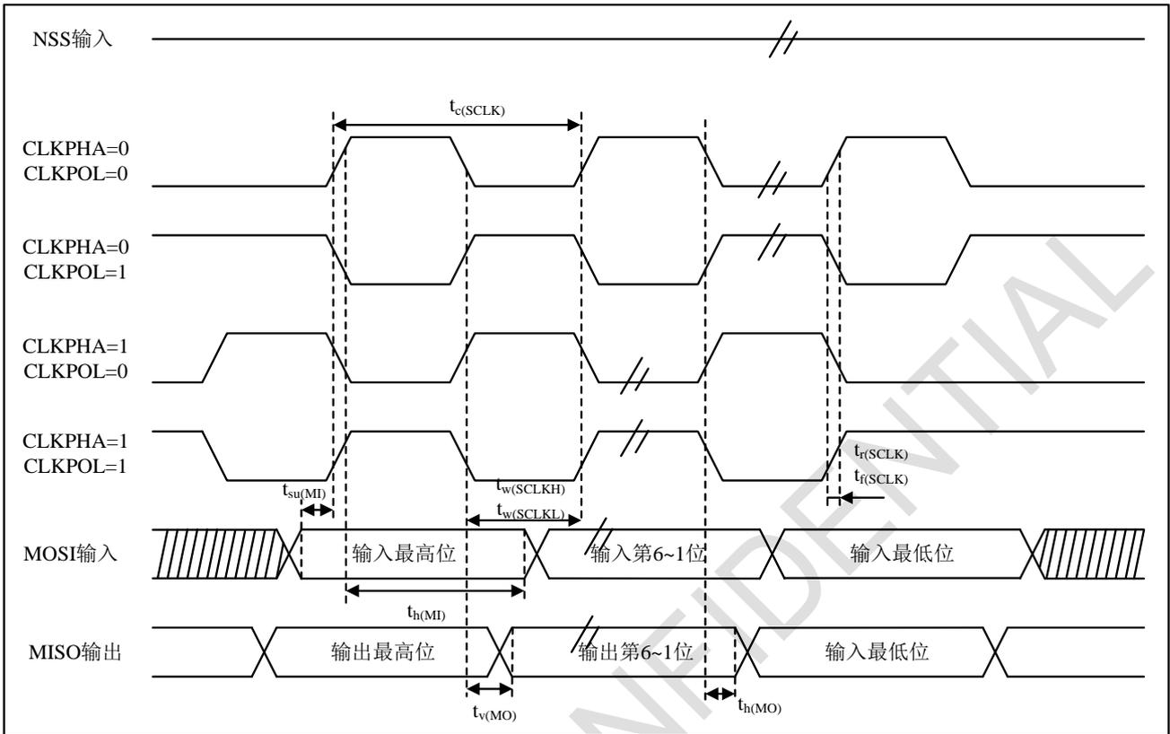
1. 测量点设置于CMOS电平：0.3V<sub>DD</sub>和0.7V<sub>DD</sub>。
