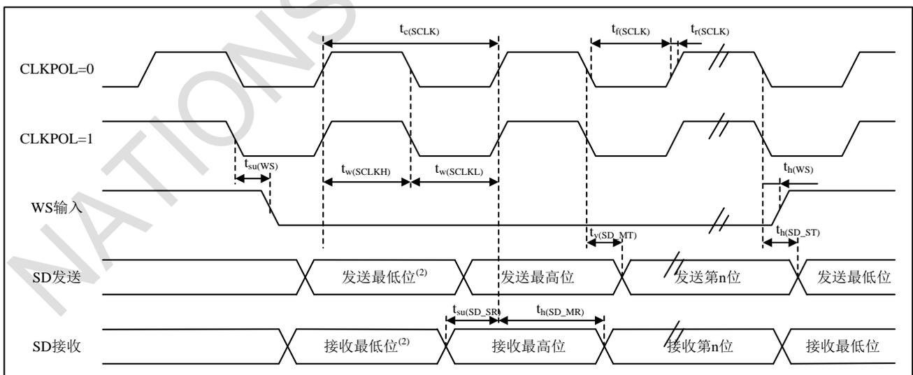
1. 测量点设置于CMOS电平：0.3V<sub>DD</sub>和0.7V<sub>DD</sub>。
