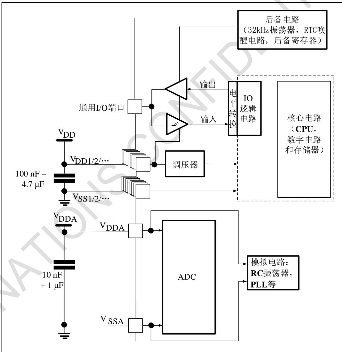
注：上图中的4.7 $\mu$ F电容必须连接到 $V_{DD}$ 。
