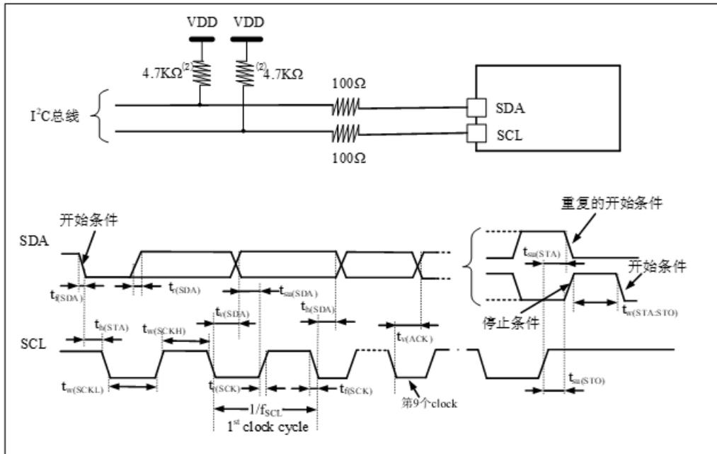
1. 测量点设置于CMOS电平：0.3V<sub>DD</sub>和0.7V<sub>DD</sub>。
