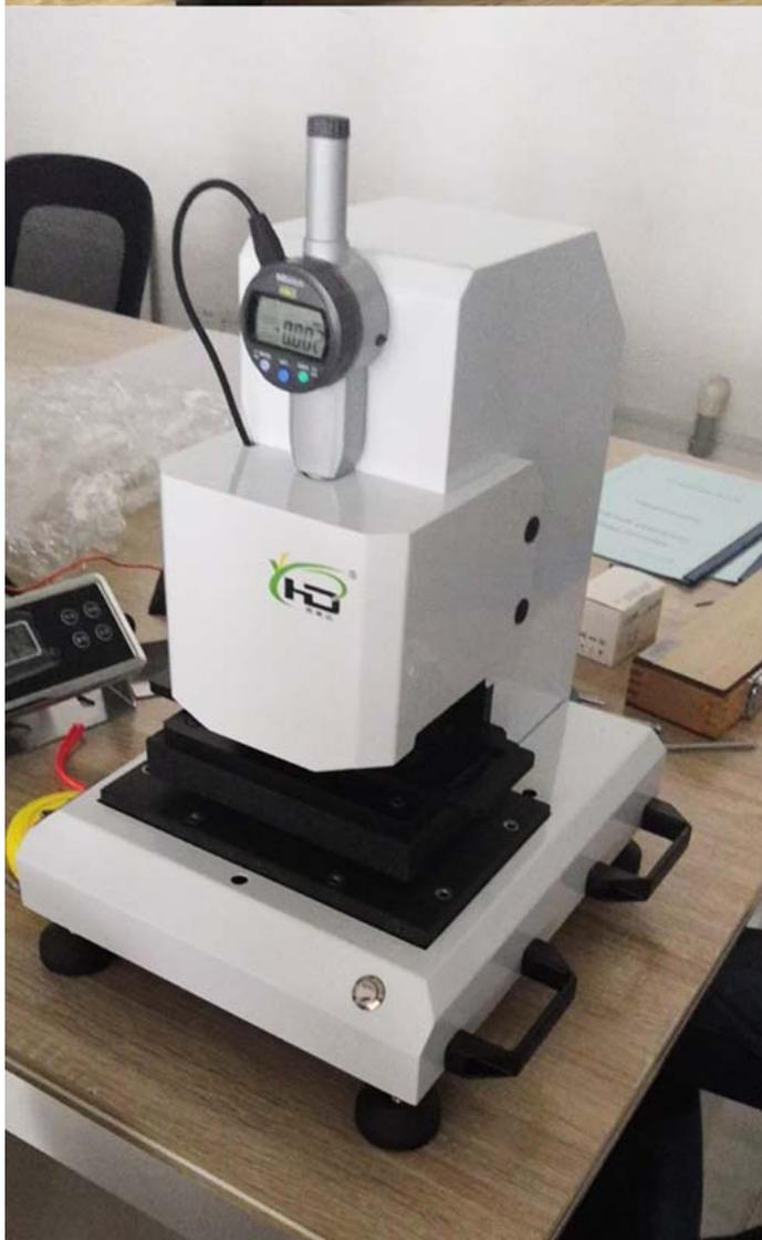
PPG测厚仪 电池测厚仪 PPG测量仪 软包电池测厚
