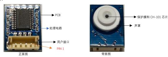
注意: (1) PCB 的外观尺寸,定位孔位置则以最终客户确认的尺寸为准 (2) 声罩的颜色不影响产品性能,除非客户提出特别要求外,默认发货颜色为白色
