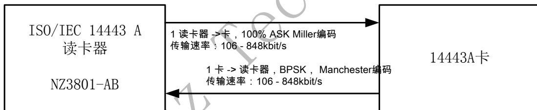
图 4 TypeA 物理层通信方式
