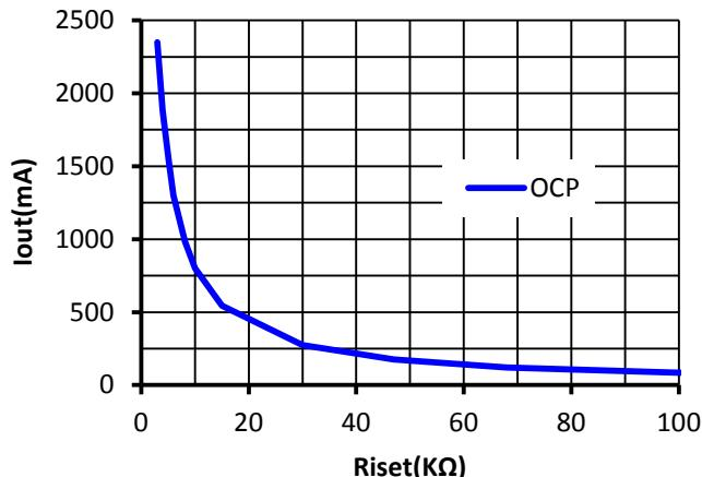
R<sub>iset</sub> vs I<sub>limit</sub> @V<sub>IN</sub>=5V
