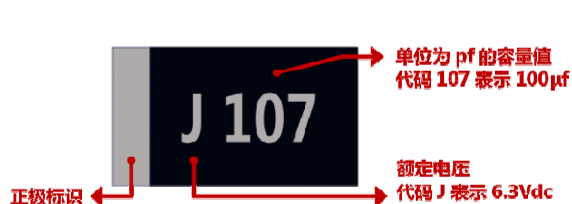
图 1 规格为 6.3V100B 的产品打印标识图示
